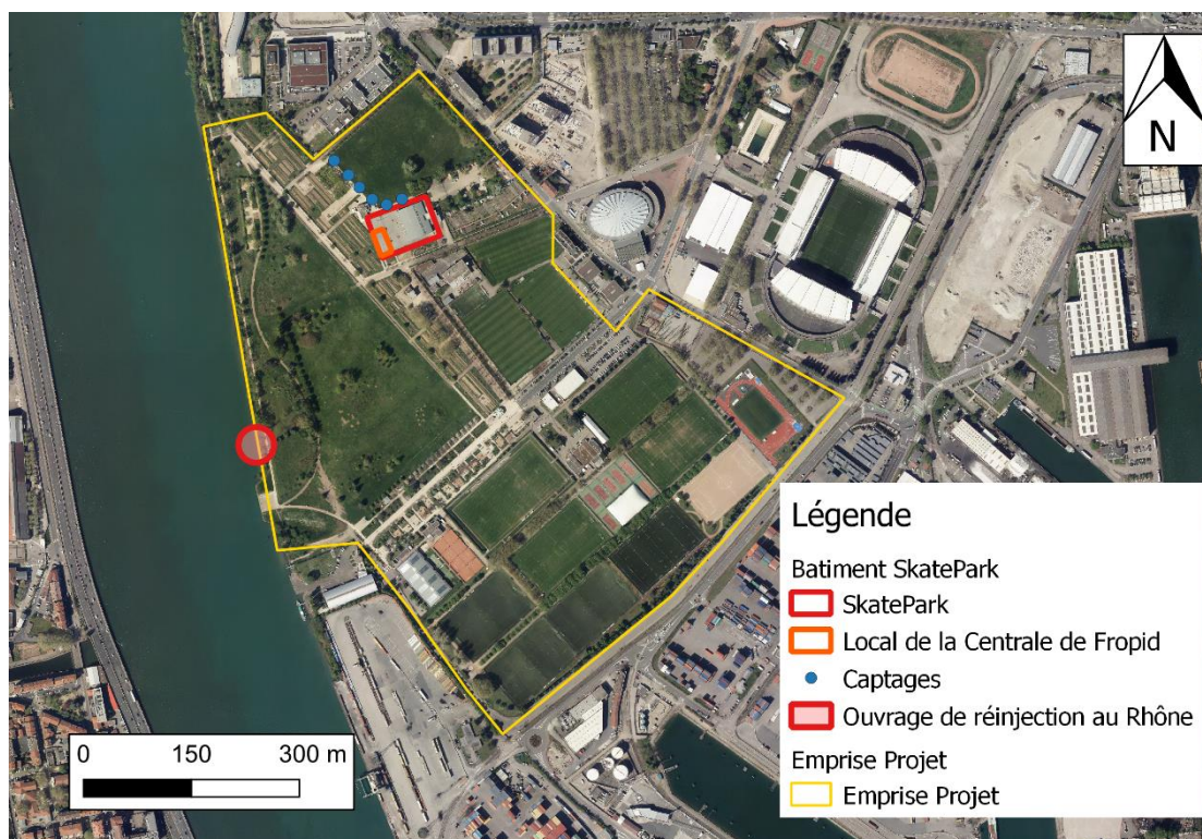
Figure 28 : Localisation du local de la Centrale de Froid par rapport au dispositif de captages / Rejet
